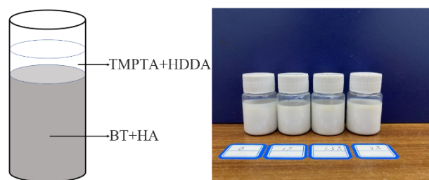
图7 不同增稠剂含量对浆料的沉降变化
